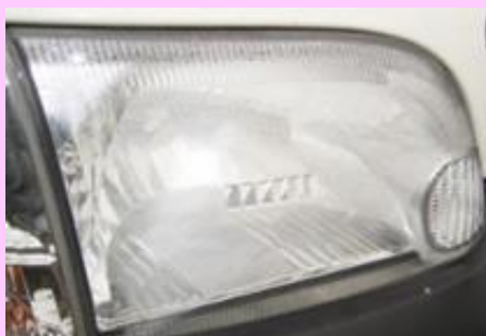
内部リフレクタの劣化
